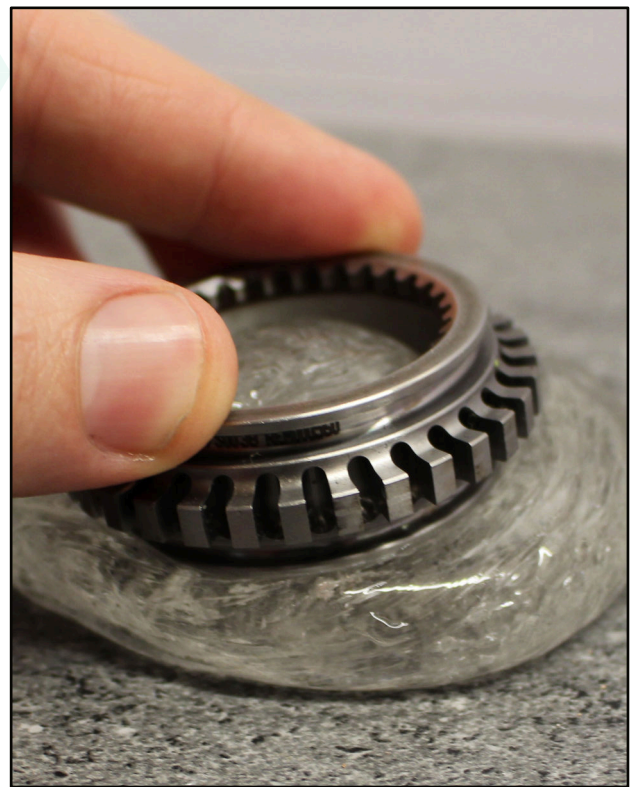
RE-FORM souple après chauffage accueillant une pièce à maintenir.
